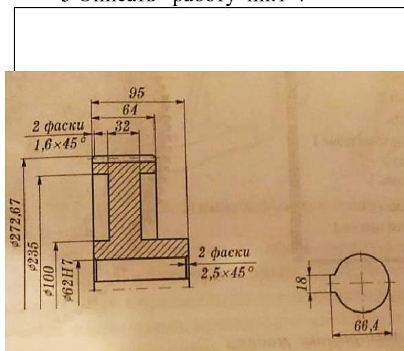
Рисунок 1 – Чертеж колеса
