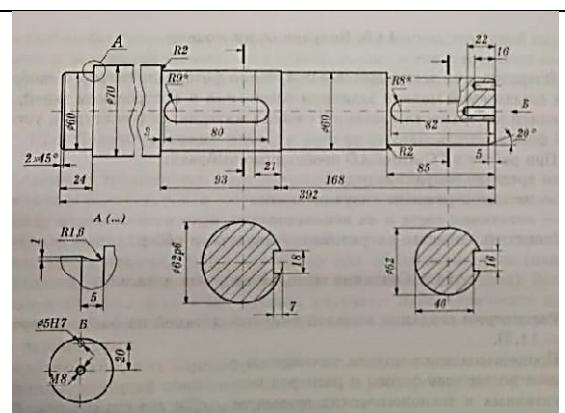
Рисунок 2 – Чертеж вала
